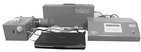
图 1 测汞仪装置 Fig. 1 Apparatus of mercury vapor analysis
