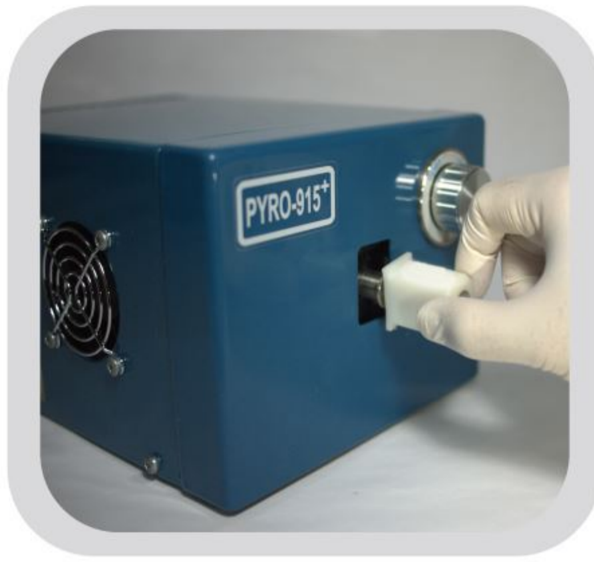
将样品舟放入热裂解器
